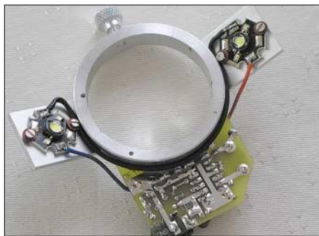
Bild 1: Die beiden auf geneigt angebrachten Aluminiumprofilen befestigten LEDs leuchten das eingespannte Objekt blend- und schattenfrei aus.
