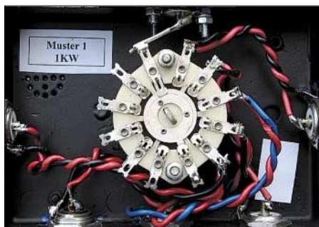
Bild 2: Robuster Keramikschalter mit zehn Stellungen, bis 1 kW gut geeignet
