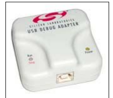
Bild 6: Der USB-Debug-Adapter (Codename EC3) verbindet den PC mit den JTAG-Anschlüssen des Controllers.
