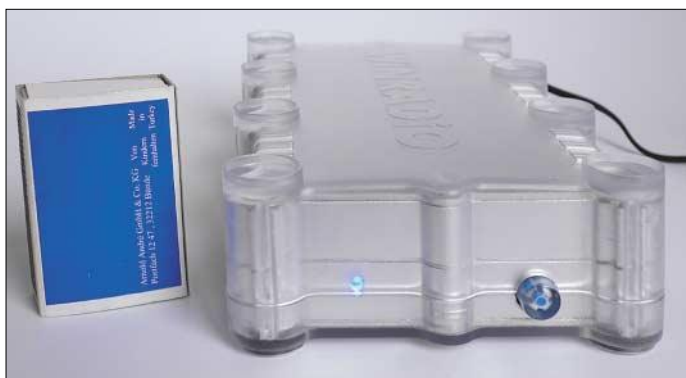
Bild 1: Vorderansicht des G313e mit Betriebszustands-LED und Einschalter
