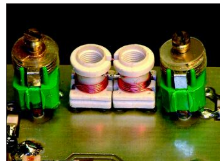
Bild 2: Bandfilter L11/C41, L12/C42 am Eingang des DDS-Nachverstärkers
