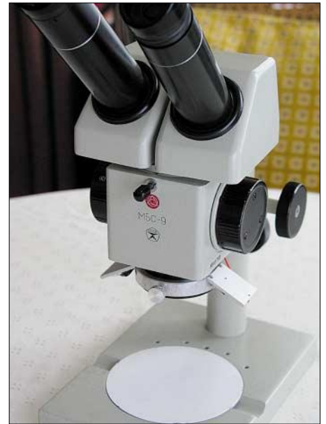
Bild 4: Mit der zusätzlich angebrachten drehbaren Beleuchtung sind Arbeiten unter dem Stereomikroskop sicher zu erledigen.
