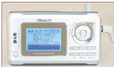
Das LC-Display ist gut abzulesen und sehr aussagefähig; wenn die Sendeanstalten mitspielen, könnte es noch mehr an Infos bieten.
