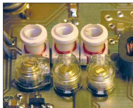
Bild 4: Dreikreisiges Filter L5/C28 ... L7/ C30 am Ausgang des Taktoszillators
