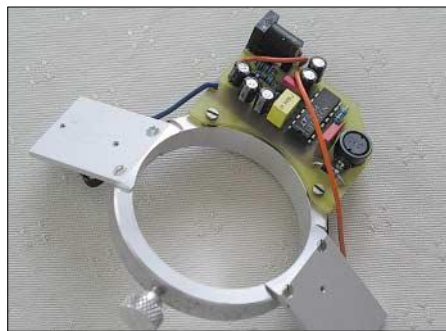
Bild 2: Von der ebenfalls am Aluminiumring angeschraubten Ansteuerplatine sind möglichst kurze isolierte Drähte zu den beiden LEDs zu führen. Fotos: OE1MSA
